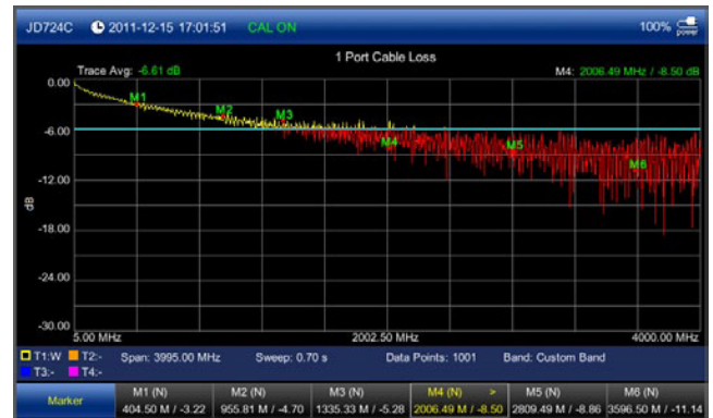
Pérdida de cable de 1 puerto
